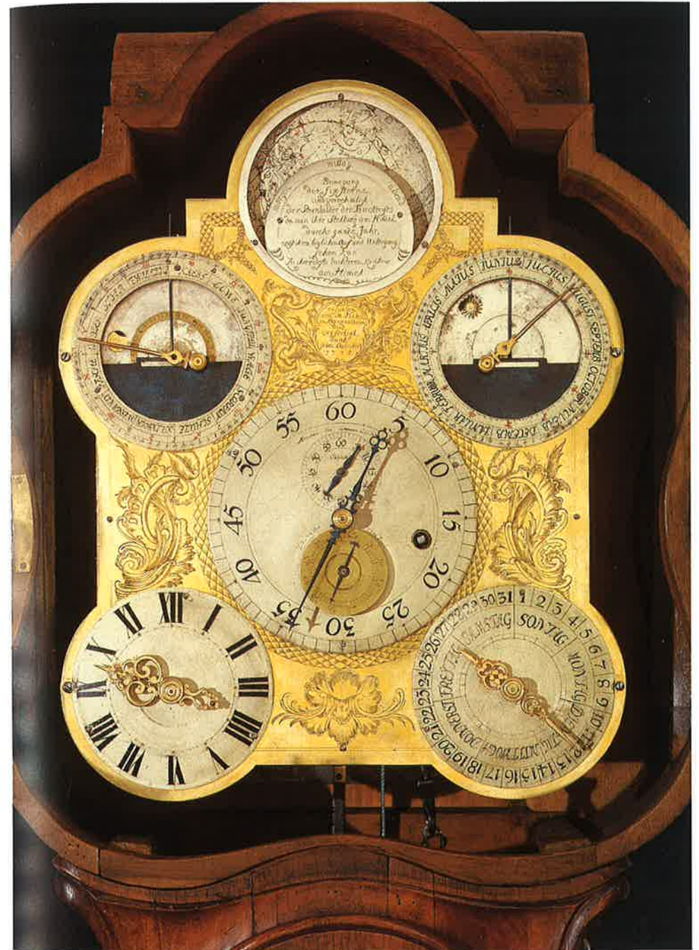
Abbildung 5. Die sechs Anzeigen und Zifferblätter: Minuten (mittlere und wahre Zeit) und Sekunden (Mitte); Stunden (unten links), Kalender (unten rechts); Mond (oben links), Sonne (oben rechts), je mit beweglichem Horizont; Fixsternhimmel (ganz oben Mitte).
