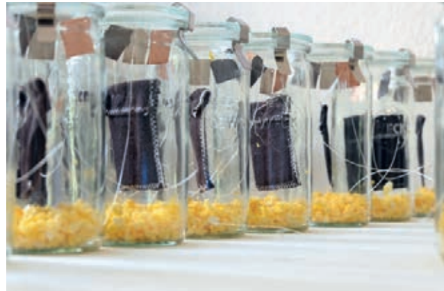
Abb. 6 Die Behältnisse mit den in die Schutzmaterialien eingepackten Coupons während der beschleunigten Degradation.
